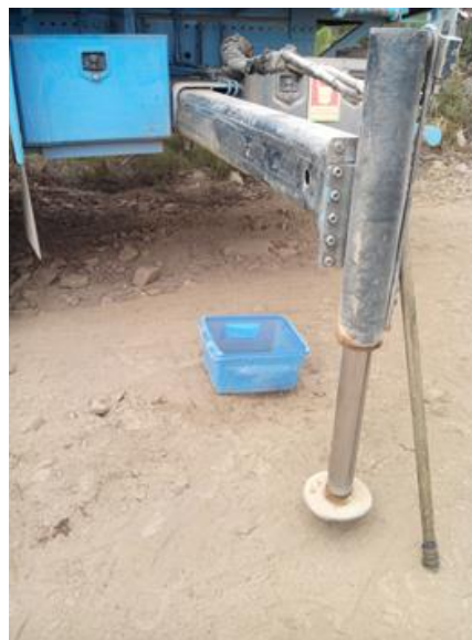
Fig. 2 – Colocação de bacia de retenção.
